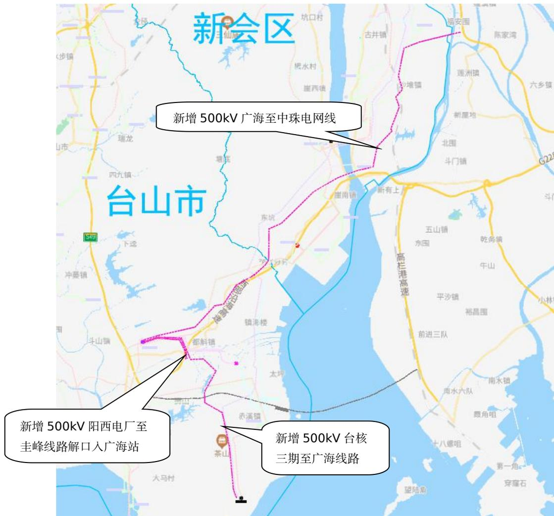
图 6.3-25 规划台山核电 5-6 号机组接入系统工程线路路径规划图
