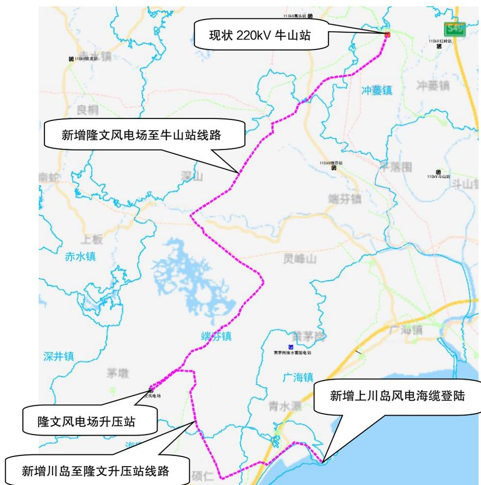
图 6.3-27 220 千伏川岛升压工程线路路径规划图
