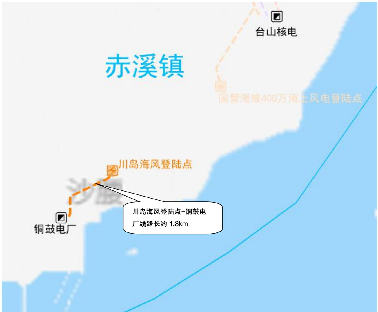
图 6.3-21 江门川岛场址海上风电接入系统工程线路路径规划图
