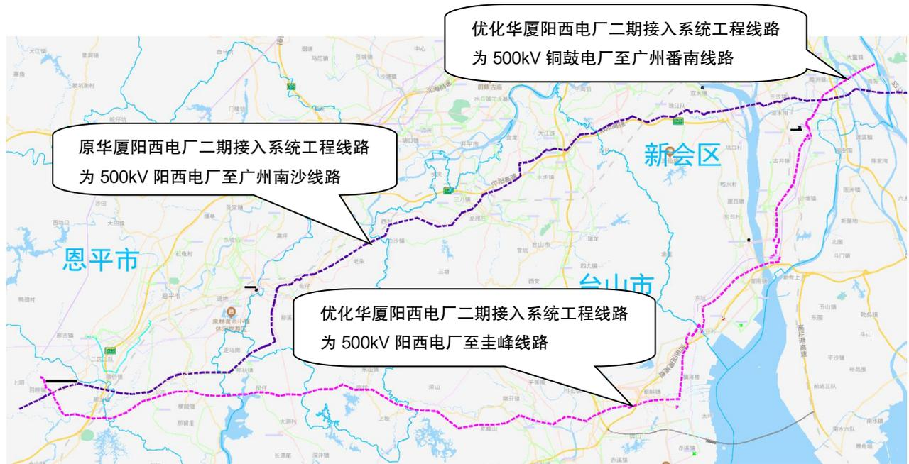
图 6.3-21 华夏阳西电厂二期接入系统工程线路路径规划图
