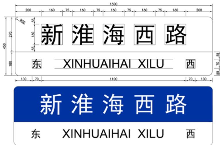
图B.3 A型5字牌面布置图(单位: mm)
