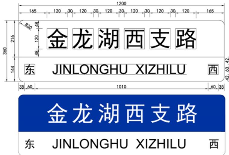
图B.8 B型6字牌面布置图（单位：mm）
