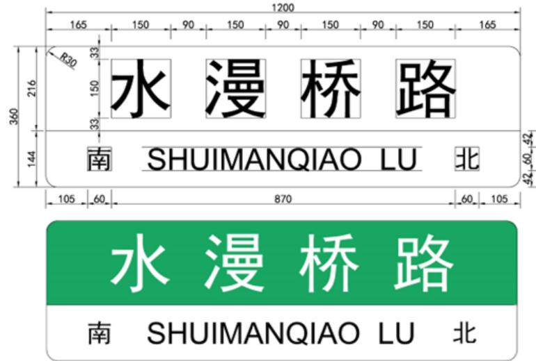
图B.6 B型4字牌面布置图（单位：mm）
