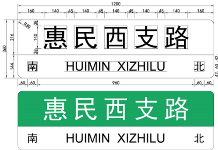
图B.7 B型5字牌面布置图（单位：mm）
