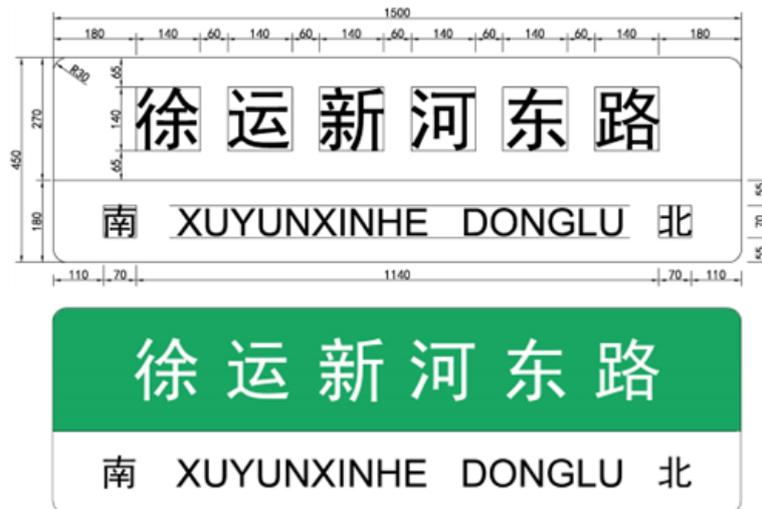
图B.4 A型6字牌面布置图(单位: mm)
