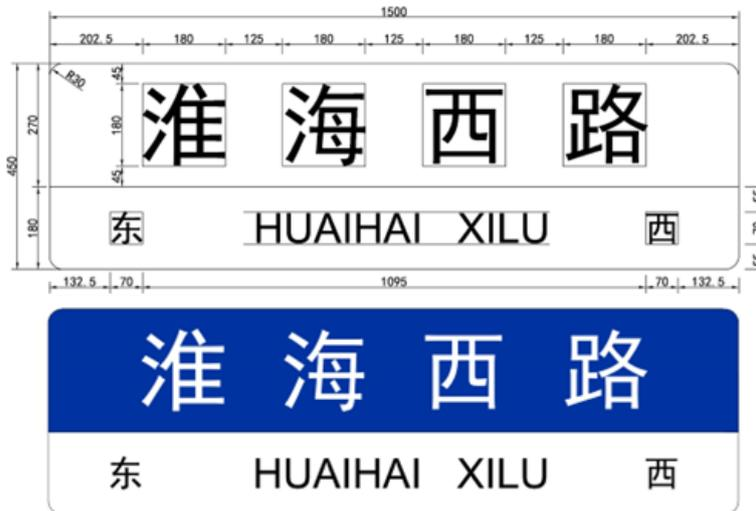
图B.2 A型4字牌面布置图(单位: mm)
