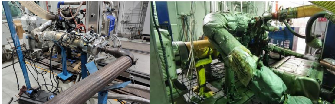
图 2-1-6 台架法规循环试验照片：匹配玉柴 YCY30 发动机（左）；匹配潍柴 WP10 发动机（右）
