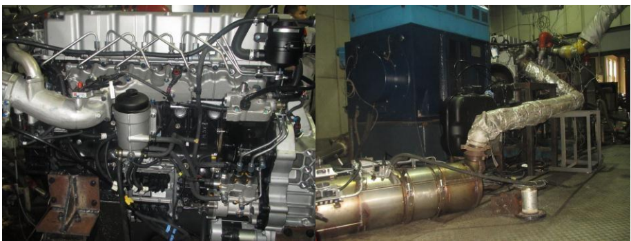
图 2-1-7 台架耐久试验发动机照片（左）；耐久试验催化器照片（右）
