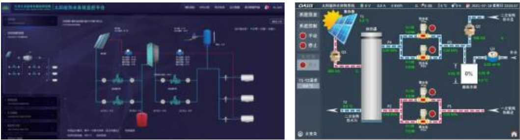
图 2-14-6 一体化机组城区级监测系统（左）和机组本地控制系统（右）
