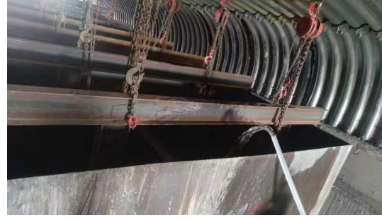
图 1.4 水箱下拉施加牵引力
