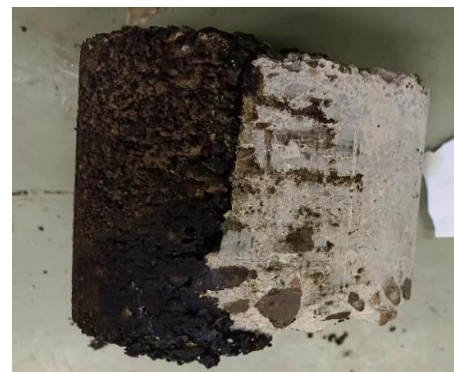
说明图 5 采用界面处理剂的冷再生拼接
