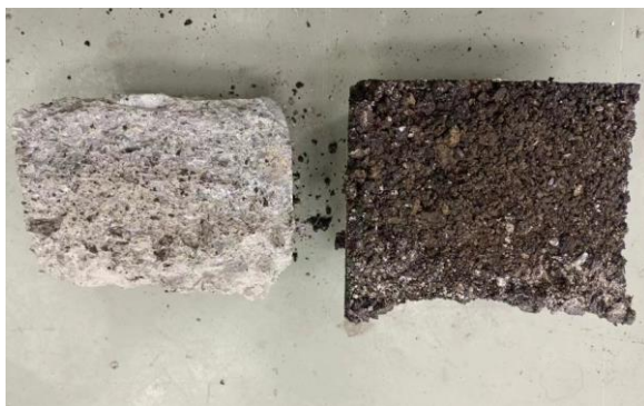
说明图 4 未采用界面处理剂的冷再生拼接
